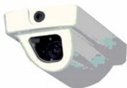
EX7C | Spezielle Farbkamera für Deckenmontage | Besonders geeignet für Flure und Eingangsbereiche | vandalismusresistentes Gehäuse aus Aluminiumguss | nahezu unzerbrechliches Polykarbonatfenster | ideal für Schulen, Gefängnisse, Banken, usw. | 1/3"-Interline SuperHAD CCD Sensor | Auflösung 480 TVL | Empfindlichkeit 2,7 Lux bei F1.4 | Spannungsversorgung 12 bis 24V AC oder DC | Gewicht 1,2 kg | Abmessungen (BxHxT): 138mm x 95mm x 286mm | Temperaturbereich -25 bis +60°C
