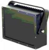
Black Diamond Hochleistungs-Infrarot Beleuchtung | geeignet für Megapixelkameras | gleichmäßige Ausleuchtung | vermeidet Unter- und Überbelichtung | 560 LEDs | 80-120W Leistungsaufnahme | Abmessungen 277 x 212 x 90mm | separates 230V Netzteil im Lieferumfang | Schutzart IP66 | 56 bis 300m Reichweite
