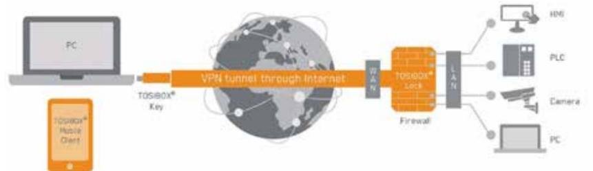
Diagramm eines Tosibox VPN-Tunnels
