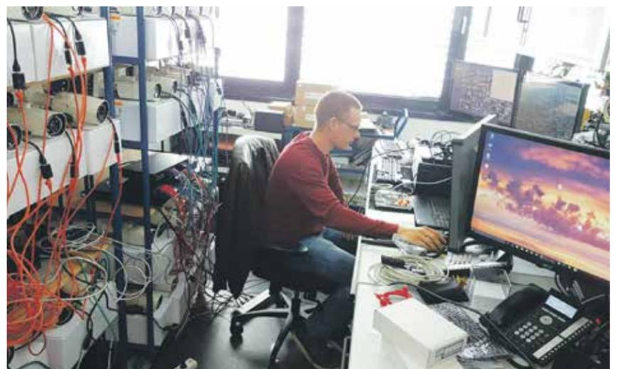
Vorkonfiguration eines Komplettsystems mit mehr als 80 Kameras, welches dann montagefertig inklusive Dokumentation ausgeliefert wurde.
