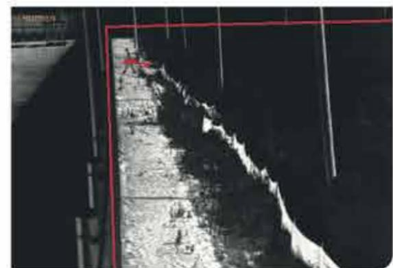
Bei der FC-Serie ID-Kamera können Sie benutzerdefinierte "Stolperdrähte" und Überwachungsbereiche einrichten, so dass nur beim Eindringen von Personen oder Fahrzeugen Alarm ausgelöst wird.
