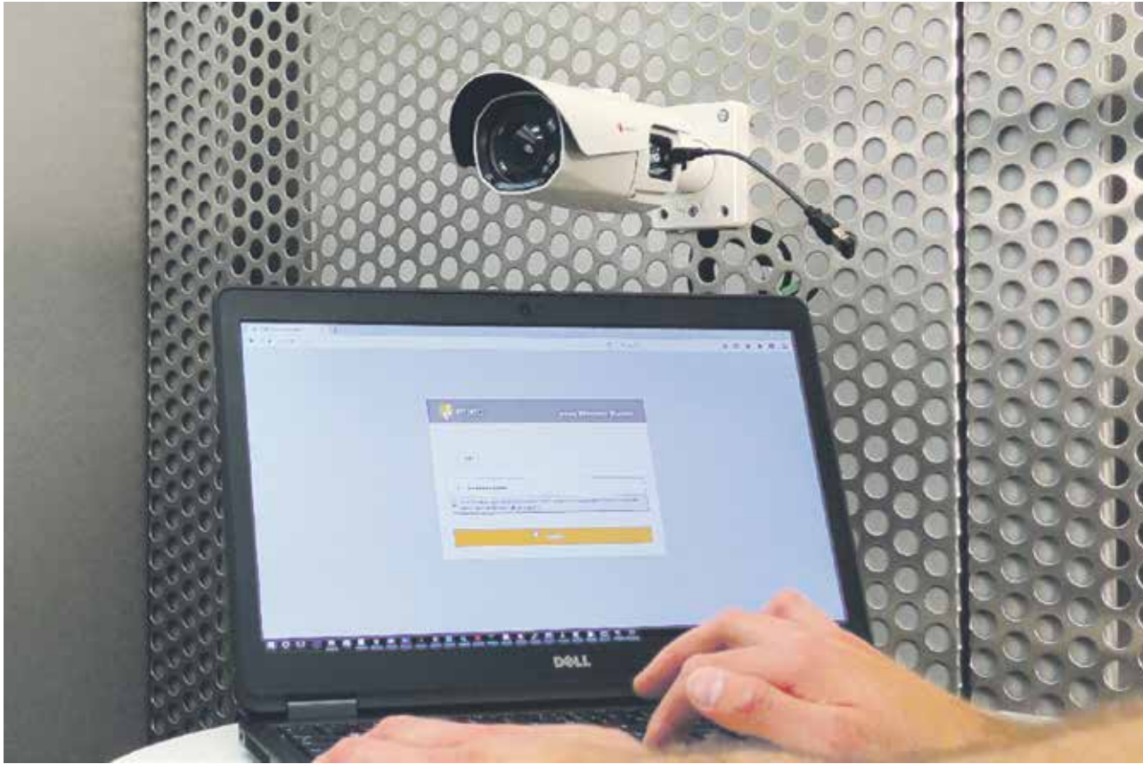
Nach Anschluss des optional erhältlichen Dongle an das WiFi-Interface der Kamera kann diese über das Funknetzwerk eingerichtet werden.
