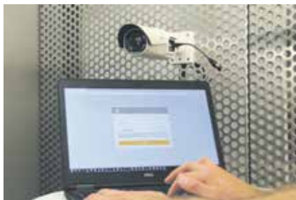
Ein weiteres Plus in Sachen Installationskomfort bietet die Push-Focus-Funktion. Die Bildschärfe wird nicht mehr direkt an der Kamera eingestellt, sondern erfolgt ebenfalls per Fernzugriff.
