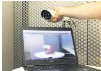
Ein weiteres Plus in Sachen Installationskomfort bietet die Push-Focus-Funktion. Die Bildschärfe wird nicht mehr direkt an der Kamera eingestellt, sondern erfolgt ebenfalls per Fernzugriff.
