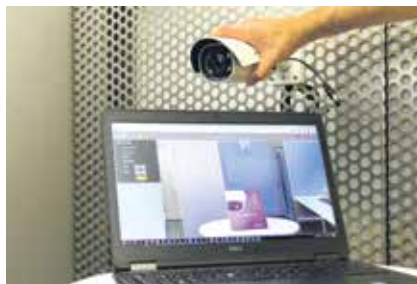
Ein weiteres Plus in Sachen Installationskomfort bietet die Push-Focus-Funktion. Die Bildschärfe wird nicht mehr direkt an der Kamera eingestellt, sondern erfolgt ebenfalls per Fernzugriff.
